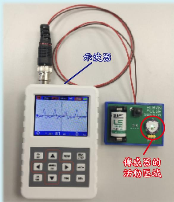
如影片所示，配置示波器。將手指輕輕放在脈搏傳感器的活動區域上（圖六），並觀察示波器上的脈搏波形。
